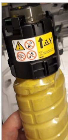
Abbildung 14: Hinweise und Richtungsanzeige des Toners
