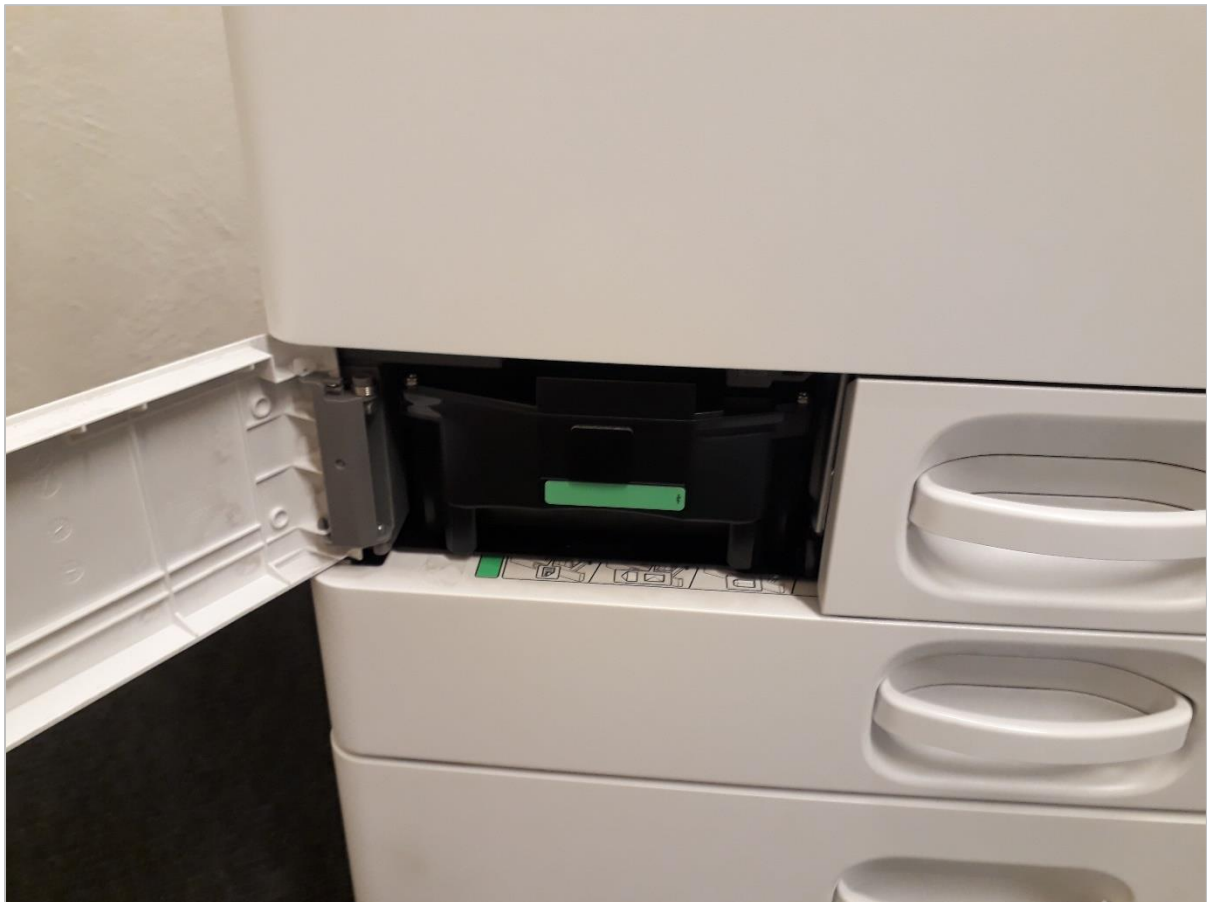
Abbildung 5: Grün markierter Resttonerbehälter, der im Ganzen gewechselt wird.
