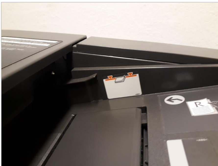
Abbildung 23: Oben: Fülllinie, rechts: bildliche Darstellung wie Vorlagen anzulegen sind.
