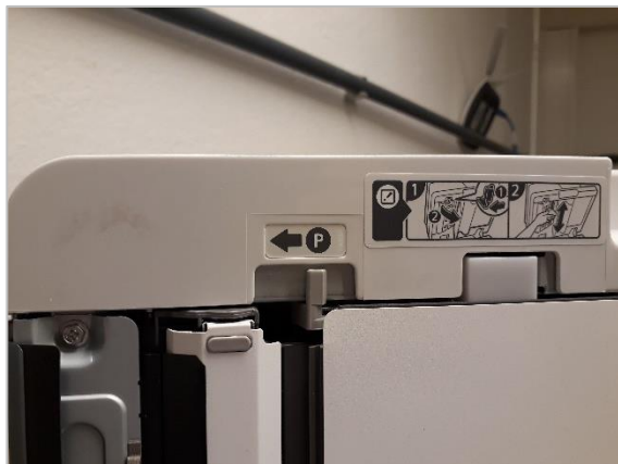
Abbildung 35: Hebel zur Öffnung des SPDF-Scanners
