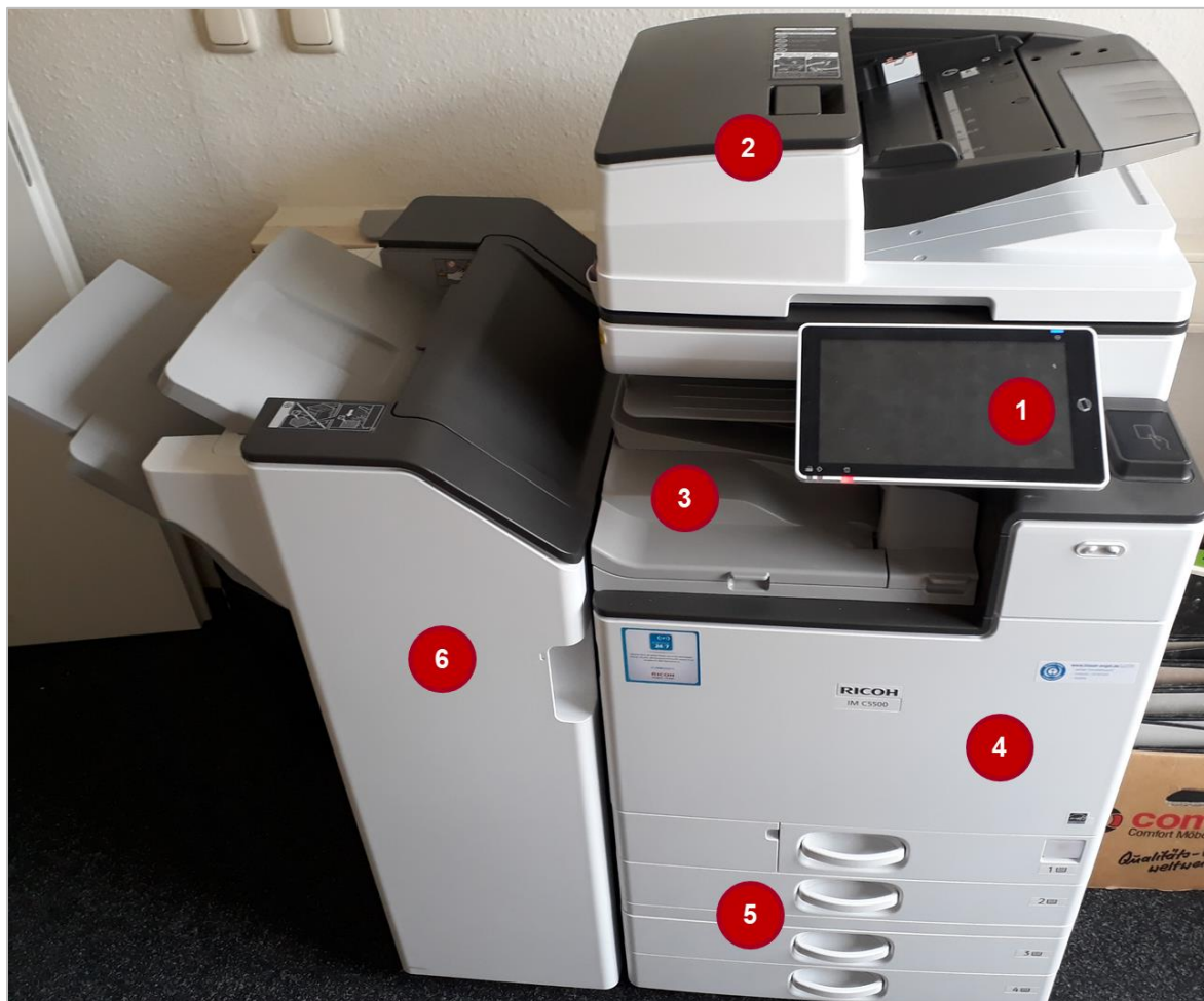
Abbildung 1: Übersicht der Funktionen – Frontansicht
