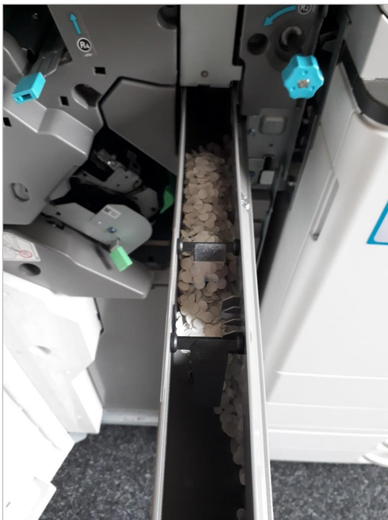
Abbildung 7: Zum Teil gefüllter Auffangbehälter für Locherreste
